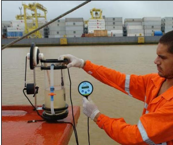
Figura 51. Oxímetro utilizado para avaliação *in situ* do oxigênio dissolvido.
