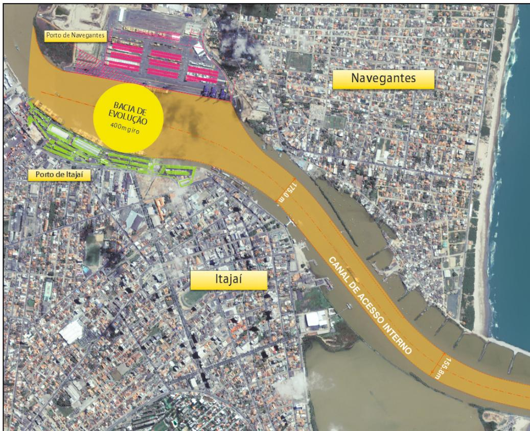
Figura 8. Detalhe para as dimensões das larguras do canal de acesso interno e bacia de evolução ao Porto Organizado de Itajaí.
