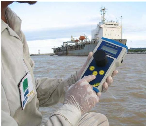
Figura 53. Turbidímetro utilizado para mensuração da turbidez *in situ*.
