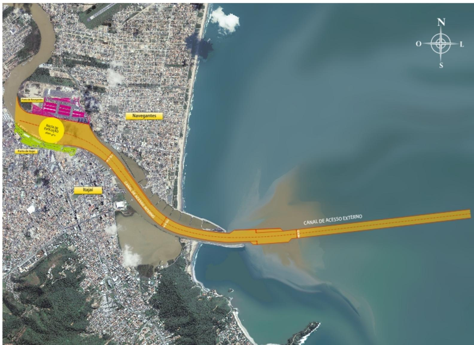
Figura 6. Delimitação da área do canal de acesso ao Porto Organizado de Itajaí alvo da dragagem de aprofundamento e adequação.
