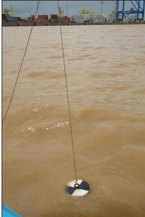
Figura 55. Disco de Secchi utilizado para a medir a transparência na coluna d'água.
