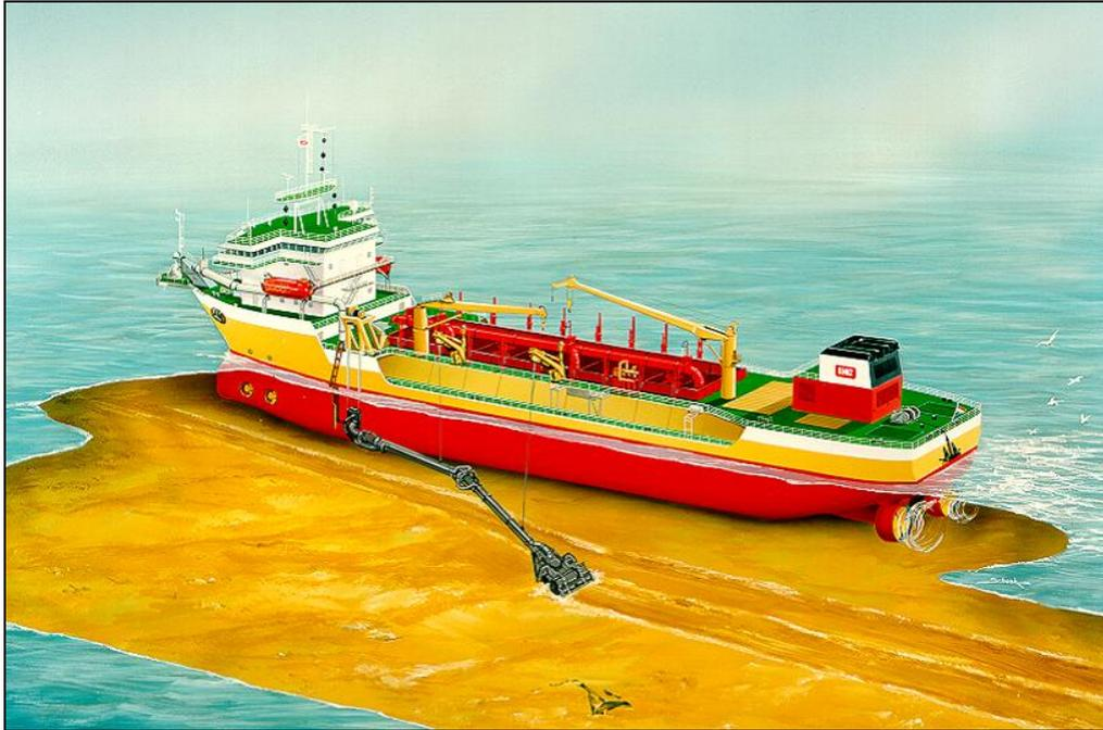
Figura 9. Ilustração de um equipamento de dragagem autotransportadora do tipo *hopper*.
