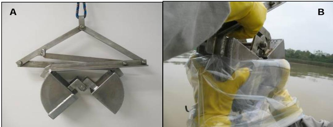
Figura 123. (A) Draga busca fundo do tipo *van Veen* utilizada para a coleta da macrofauna bentônica e (B) acondicionamento da amostra da macrofauna bentônica em saco plástico.
