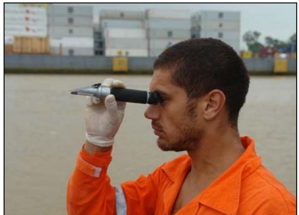
Figura 54. Refratômetro portátil utilizado para avaliação da salinidade *in situ*.
