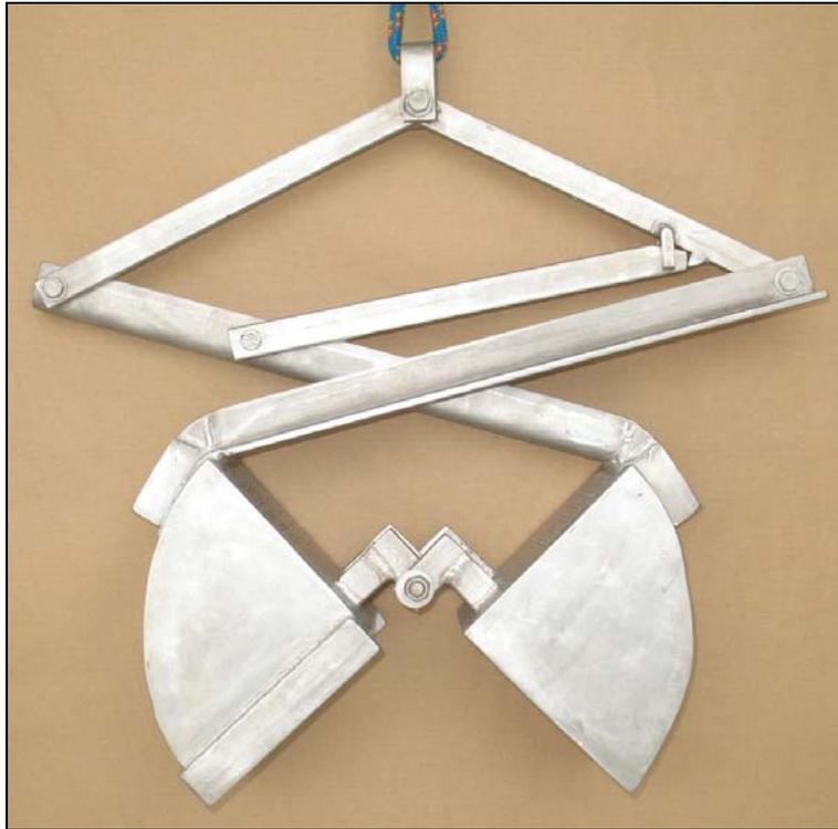
Figura 57. Amostrador do tipo *van Veen* utilizado na coleta de sedimento superficial.
