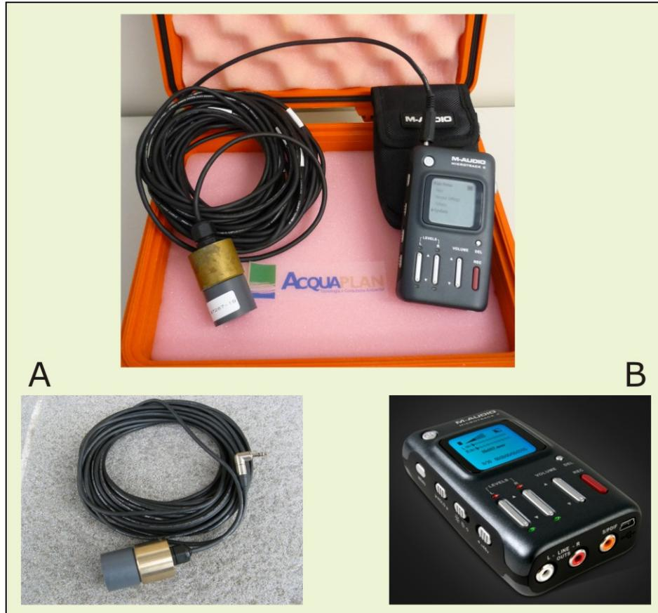
Figura 104. (A) Hidrofone *Cetacean Research SQ26-08* e (B) gravador digital *M-Audio Microtrack II*, utilizados para a coleta de dados de acústica.
